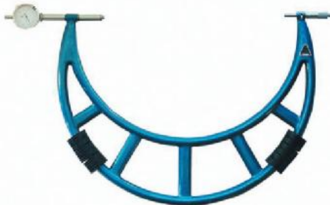
Рисунок 11 – Общий вид микрометров специальных МКД15.
