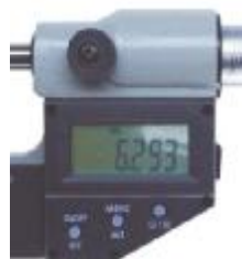
Рисунок 15 – Общий вид цифрового отсчетного устройства тип 3
