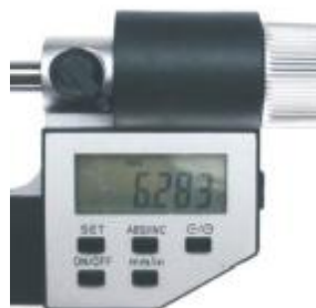
Рисунок 16 – Общий вид цифрового отсчетного устройства тип 5
