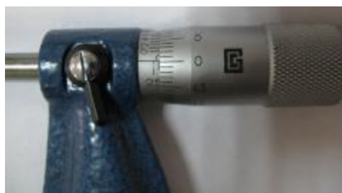
Рисунок 17 – Общий вид отсчета показаний по шкалам стебля и барабана с нониусом
