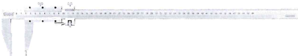
Рисунок 3- Общий вид штангенциркуля модификации ШЦ-III- с отсчетом по нониусу одностороннего.
