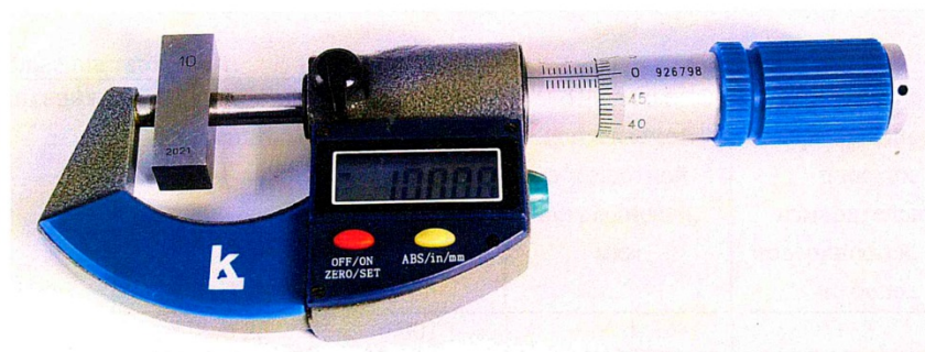
Рисунок 2 – Общий вид микрометров торговой марки «Калиброн» с цифровым отсчетным устройством.
