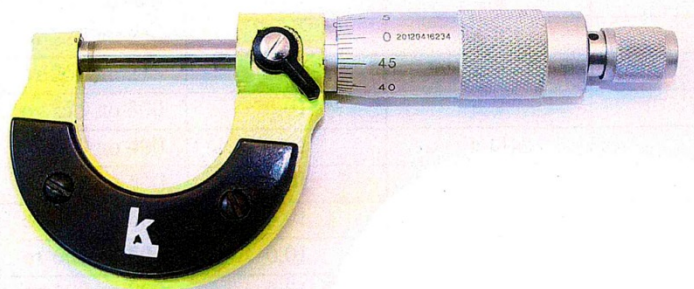
Рисунок 1 – Общий вид микрометров торговой марки «Калиброн» с отсчетом по шкалам стебля и барабана.
